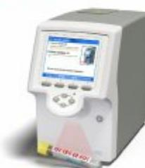
**6** Gire el tubo de ensayo. Retire la funda del tubo de ensayo y luego introduzca el tubo en la puerta para carga de tubos del analizador. El procesamiento se inicia automáticamente.
