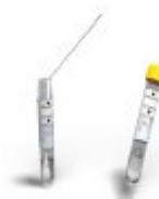
**4** Apríete firmemente el bulbo de succión de la pipeta de transferencia, Introdúzcalo en el líquido de la muestra y suéltelo para aspirar la muestra. Apriete el bulbo de transferencia lentamente para transferir la muestra al tubo de ensayo y retape el tubo de ensayo.
